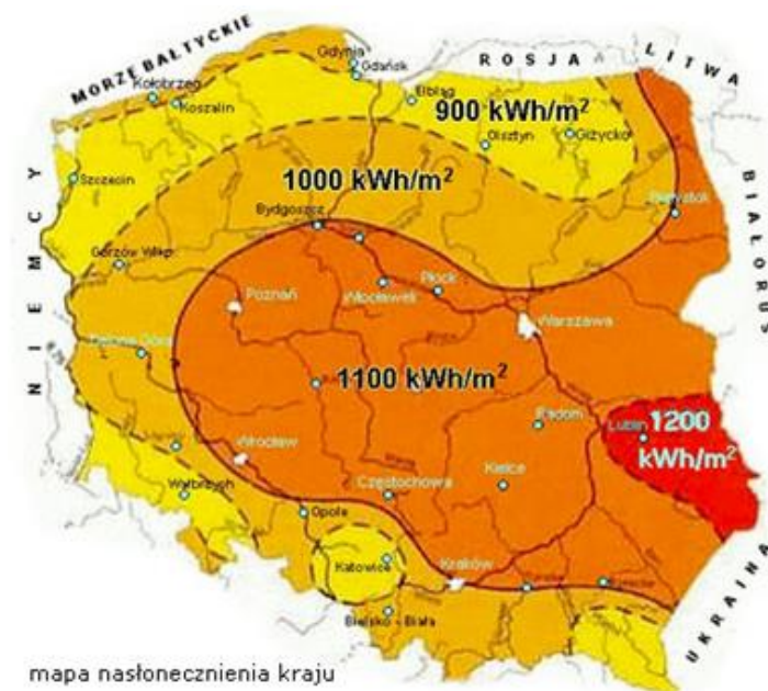
RYSUNEK 4. MAPA NASŁONECZNIENIA KRAJU. Źródło: www.instalacjebudowlane.pl
